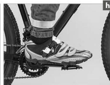
Hauptvorteil dieser Systempedale (a) ist, dass der Fuß beim schnellen Treten oder bei Fahrten im holprigen Gelände nicht abrutscht. Das Pedal kann durch den fixen Halt auch geschoben bzw. gezogen werden.
