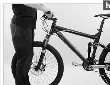
Um die Leichtgängigkeit des Lagers zu prüfen, heben Sie mit einer Hand den Rahmen hoch, bis das Vorderrad keinen Bodenkontakt mehr hat. Das Vorderrad muss ohne Einrasten von ganz links nach ganz rechts und zurück schwenken. Wenn Sie den Lenker leicht antippen, muss sich die Gabel selbsttätig aus der Mittelstellung herausdrehen (g).
