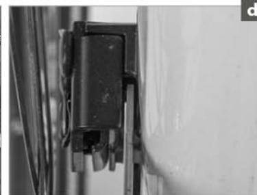
Wenn Sie mehrfach nachstellen, ändert sich die Stellung des Hebels am Bremsattel. Die Wirkung der Bremse wird schwächer. Im Extremfall kann die Bremse komplett ausfallen. **Unfallgefahr!**
