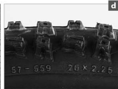
Der vom Hersteller empfohlene Luftdruck steht in der Regel auf der Reifenflanke oder dem Typenetikett. Die Untergrenze der Druckangabe bedeutet maximalen Federungskomfort für leichte Fahrer, optimal für Fahrten auf rauem Untergrund. Mit zunehmendem Druck wird der Rollwiderstand auf ebenem Untergrund minimiert, der Komfort nimmt dagegen ab. Hart aufgepumpte Reifen eignen sich daher am besten für schwere Fahrer und die Fahrt über glatten Asphalt.
