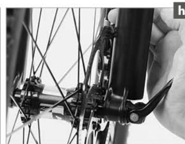
Wenn das Gewinde der Steckachse komplett aus dem Gewinde der Tauchrohre gedreht ist, können Sie die Steckachse komplett entnehmen.
